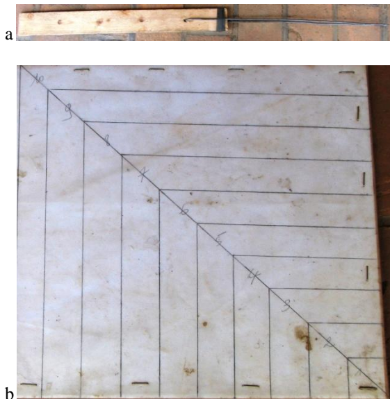
Fig. 2a,b: Outils d'analyse de la litière; a: Outil de ramassage de la litière, composé de deux fils métalliques, solides, pointus et collés ensemble avec séparation par une petite planche d'un cm; b: Plancher de carreaux pour mesurer la taille de chaque élément de la litière
