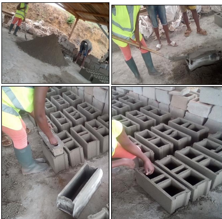
Photo 77 : Etapes de fabrication des briques-parpaings (Briqueterie de Socio)
