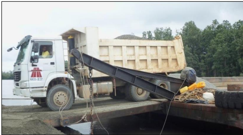
Photo 12 : exemple de quai pour le déchargement à aménager
