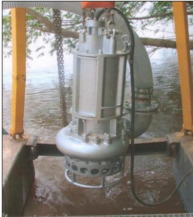
Photo 4 : exemple de pompe suceuse destinée à l'extraction de sable
